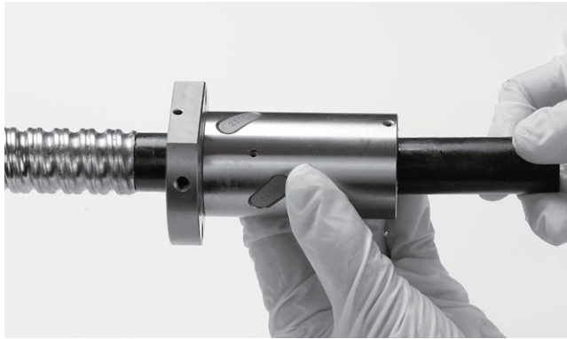
2. 将转换管对上正确尺寸的丝杠前端。
