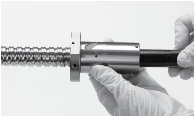
3. 将螺母顺着丝杠的螺纹转入。
