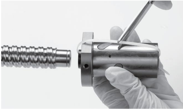
1. 将螺母上的固定线剪开。
