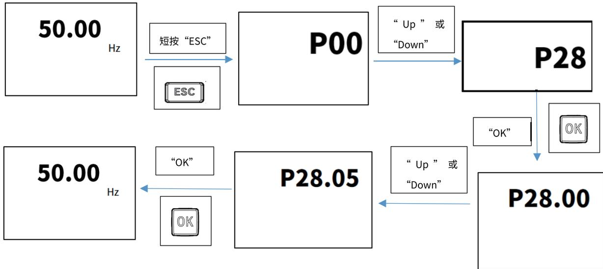
参数界面上方显示参数 ID，下方显示参数值和对应单位。查看完成后长按或短按“ESC”返回上一级直到退回至主界面。
