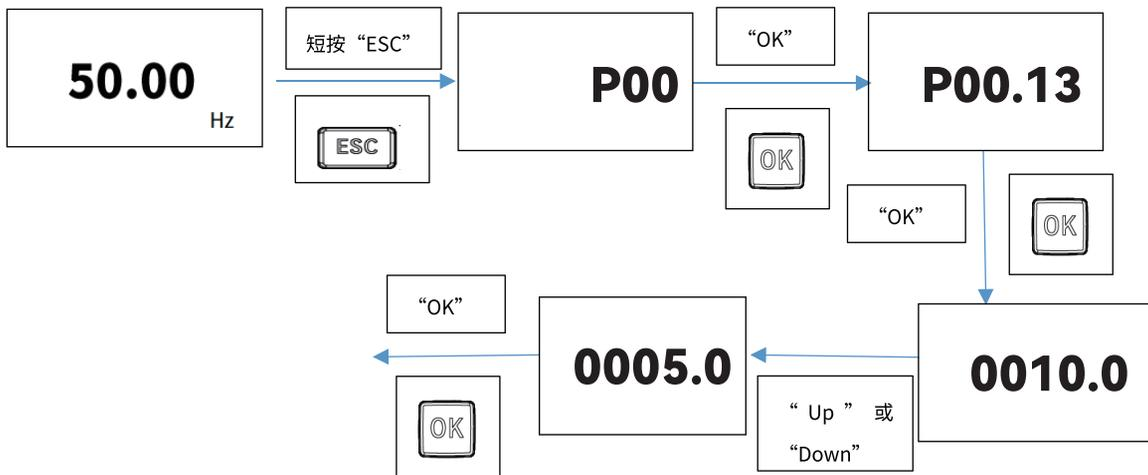
参数修改完成后按“OK”键确认，确保参数值写入变频器并保存。
