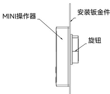
通过旋钮将操作器紧固在安装板上。
