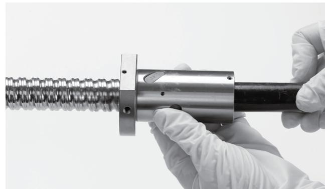
3. 将螺母顺着丝杠的螺纹转入。
