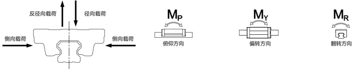
较多的使用场景是将多根导轨并行使用，这时力矩载荷会被滑块组合来共同承担，因此滑块内部的负荷分布状态比较均衡，受力状况比单根导轨使用时改善很多。计算目的是寻找最大受力的滑块以及它的平均载荷。
