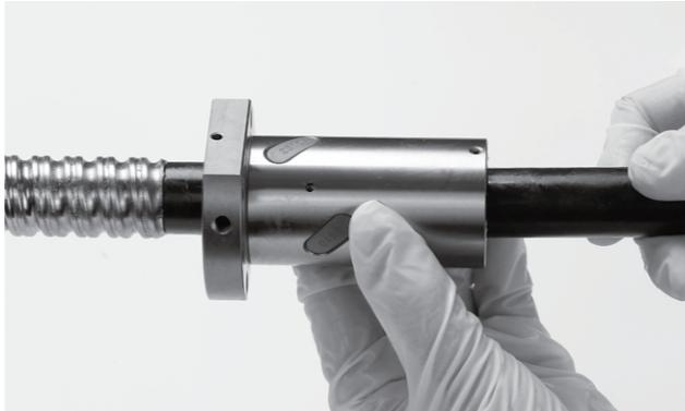
2. 将转换管对上正确尺寸的丝杠前端。
