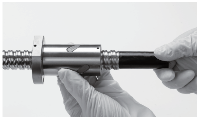
4. 将螺母全行程都转入丝杠上。 注意！确认螺母全部行程都转入丝杠后才能将转换管移开。
