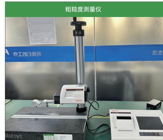
可对多种机械加工零件表面的粗糙度进行测量，包括平面、斜面、外圆柱面，曲面小孔，沟槽及车轴等。
