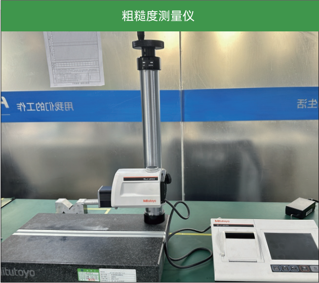
可对多种机械加工零件表面的粗制度进行测量，包括平面、斜面、外圆柱面，曲面小孔，沟槽及车轴等。
