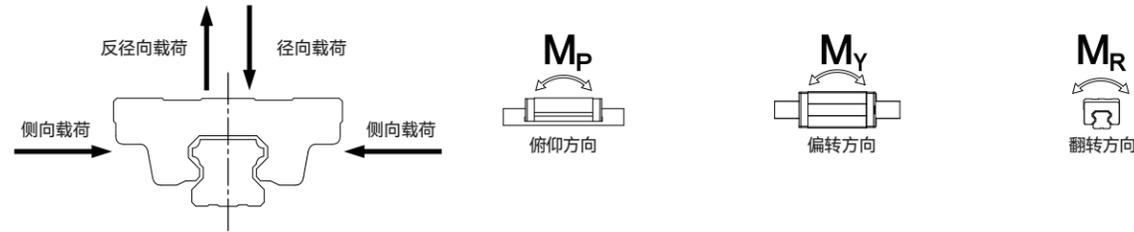
较多的使用场景是将多根导轨并行使用，这时力矩载荷会被滑块组合来共同承担，因此滑块内部的负荷分布状态比较均衡，受力状况比单根导轨使用时改善很多。计算目的是寻找最大受力的滑块以及它的平均载荷。
