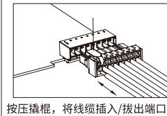
按压撬棍，将线缆插入/拔出端口
