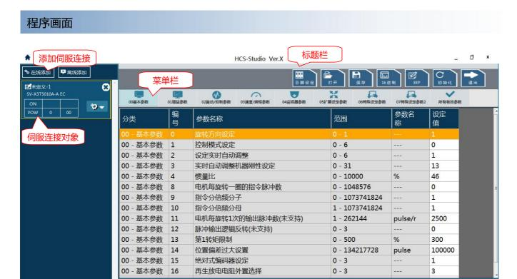
0:正方向指令时,电机旋转方向为CW方向(从轴侧看电机为顺时针方向) 1:正方向指令时,电机旋转方向为CCW方向(从轴侧看电机为顺时针方向)
