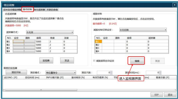
点击 "编辑" 后,以下区域可用,可以设定(或编辑)指定编号的频率、滤波器,完成编辑后发送到伺服驱动器
