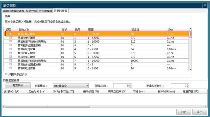
输入修改值,点击"确定"按钮完成参数设定
