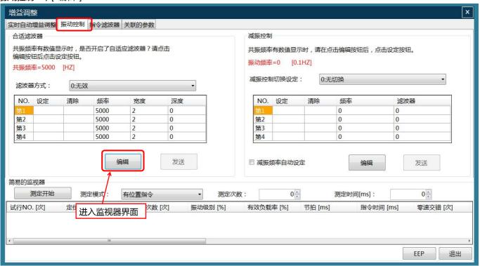
点击"编辑"后,以下区域可用,可以设定(或编辑)指定编号的滤波器频率、宽度、深度,完成编辑后发送到伺服驱动器
